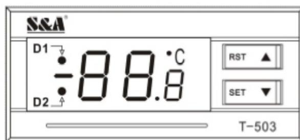
Indicatori D1, D2 (come mostrato) del termostato stato operativo ON D1: termostato lavora in modalità di controllo intelligente; D1 OFF: termostato lavora in modalità di controllo della temperatura manuale.
