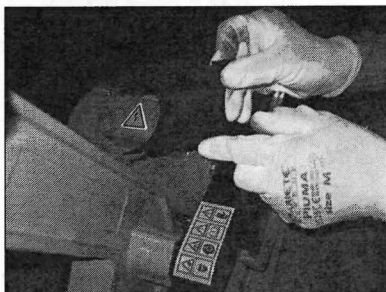
Figura 11 – Montaggio seconda parte del carter della cinghia
