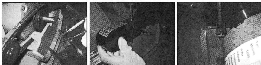
Figura 10 – Montaggio prima parte del carter della cinghia
