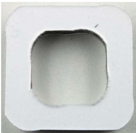
Il contorno tagliato del lato inferiore del materiale mostra un piccolo errore di contorno
