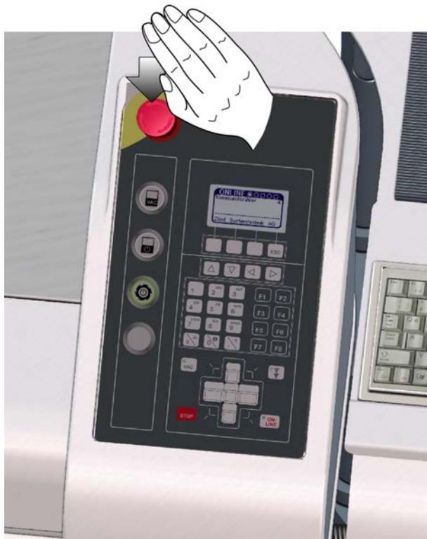
In presenza di un pericolo o di una situazione potenzialmente pericolosa premere senza indugio un apparecchio di comando di ARRESTO DI EMERGENZA.
