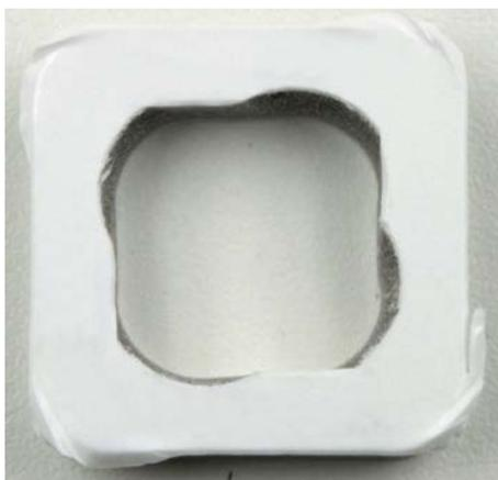
Il contorno tagliato del lato superiore del materiale contiene l'errore di contorno dovuto alla sovrapposizione
