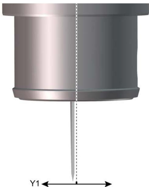
Se il filo della lama non poggia esattamente sul punto zero, viene eseguito un taglio che corre parallelamente al percorso di lavorazione originale.
