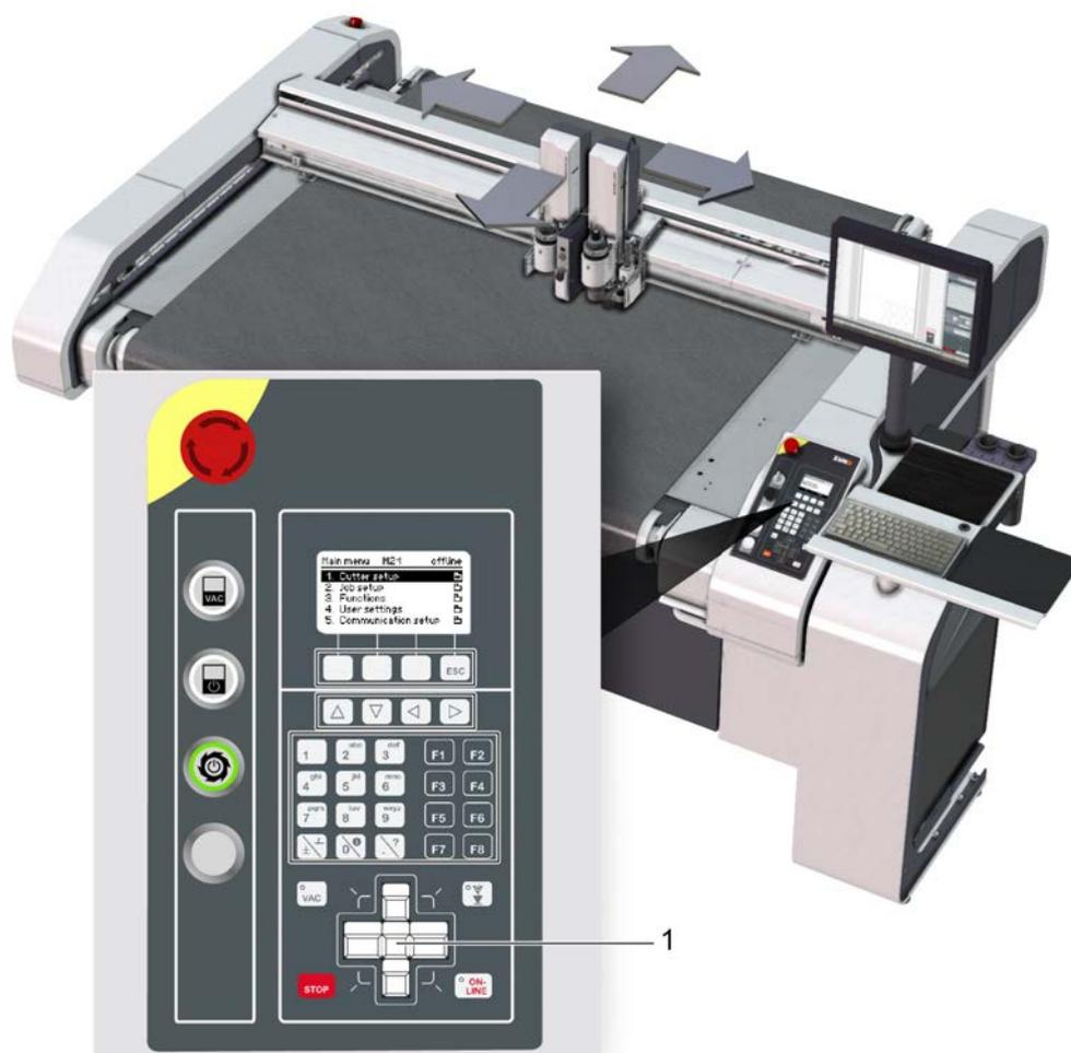
Nelle modalità operative OFFLINE e STOPPED è possibile spostare il supporto del modulo con i tasti di spostamento. La disposizione dei tasti corrisponde alla direzione dello spostamento.
