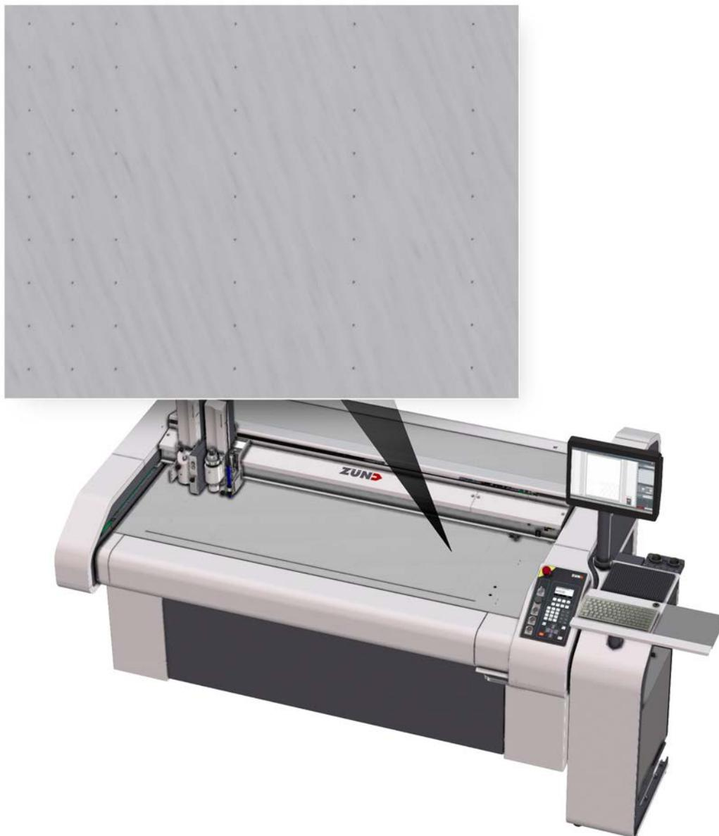
Il fissaggio del materiale sulla superficie di lavoro viene effettuato attraverso il vuoto. La superficie di lavoro consiste in una stabile piastra forata in plastica. A seconda dell'utilizzo le piastre sono disponibili con fori di diverse dimensioni e pattern. Se il cutter è dotato di piastre forate di plastica "standard" e "lamina", la larghezza del vuoto è a regolazione continua. Se il cutter ha una piastra forata di plastica "pelle", la larghezza del vuoto non è regolabile.
