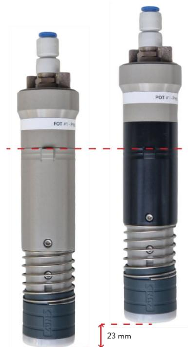
Con la bussola, l'utensile si alza di 23 mm e si può tagliare materiale più spesso. Dotarsi di chiave a brugola da 2,5 mm, **bussola completa sollevamento utensile** e vaselina che si trovano nella cassetteria CS2 nel locale Lab. CNC.
