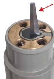
A fine lavorazione, se si smonta l'utensile POT dal modulo, ricordarsi di rimettere il tappo per evitare che entri polvere che potrebbe danneggiare il sistema.
