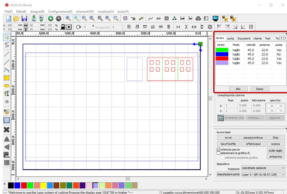
Set the item **modalità di** on **scansione**. For the items **velocità** (speed) and **potenza** (power), copy the **values** related to **scansione** found in the **note for each material** in the **window parametri libreria**.
